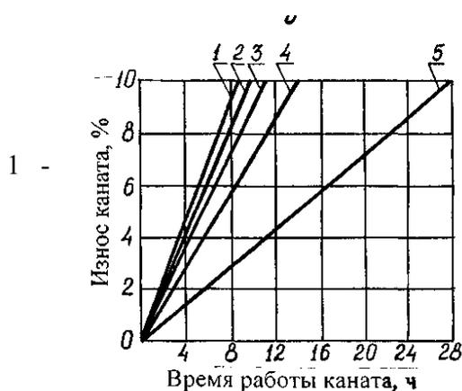
**Рис. 2. Зависимости площади пиления и износа каната от времени его работы при использовании в качестве абразива:**
