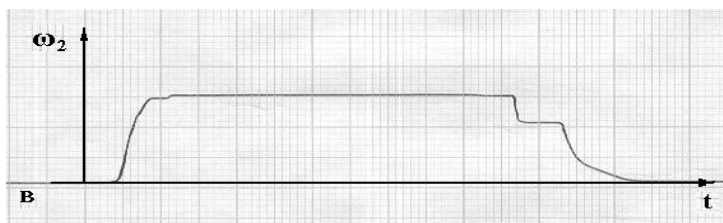
Рис.1. Диаграммы изменения угловой скорости исполнительного органа ММП-50 при холостом режиме работы (а), средней подаче (б) и высокой подаче (в) измельчаемого материала.
