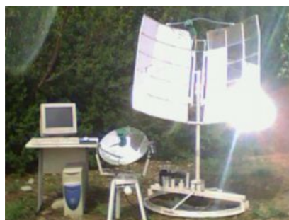
Рис.1. Разработанный опытный образец КСИ параболоидной формы с приемником солнечного излучения
