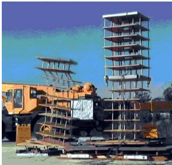
Рис. 1.4. Идентичные модели здания при испытании на сеймоплатформе до разрушения
