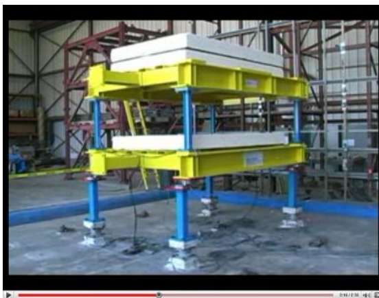
Рис. 1.13. Испытание фрикционно-маятниковой опоры
