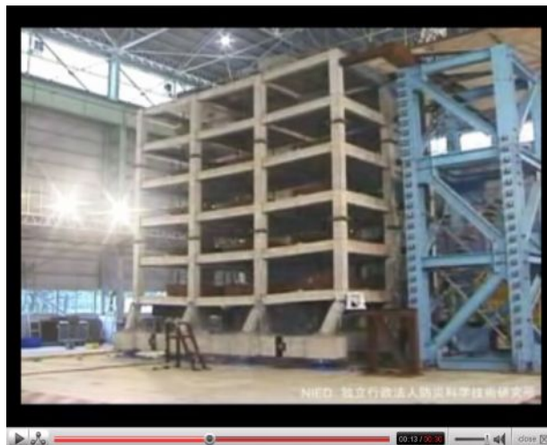
Рис. 1.5. Испытание железобетонного здания на сеймоплатформе
