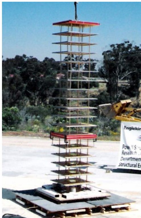
Рис. 1.2. Модель 18-этажного здания на виброплатформе
