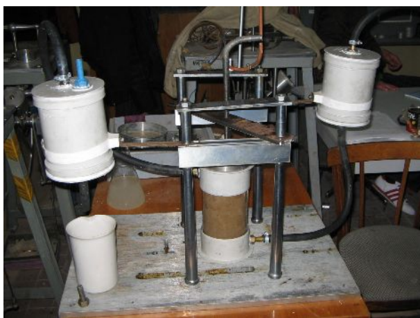
Рис. 2. Общий вид прибора для лабораторного закрепления просадочных лессовых грунтов
