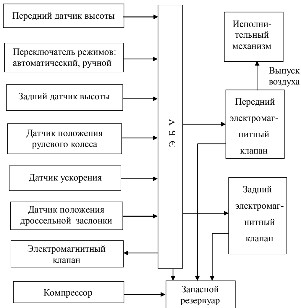
Рис. 2. Структурная схема управления жесткостью подвески автомобиля “Toyota”
