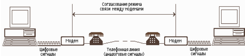
Рис. 5. Схема реализации модемной связи
