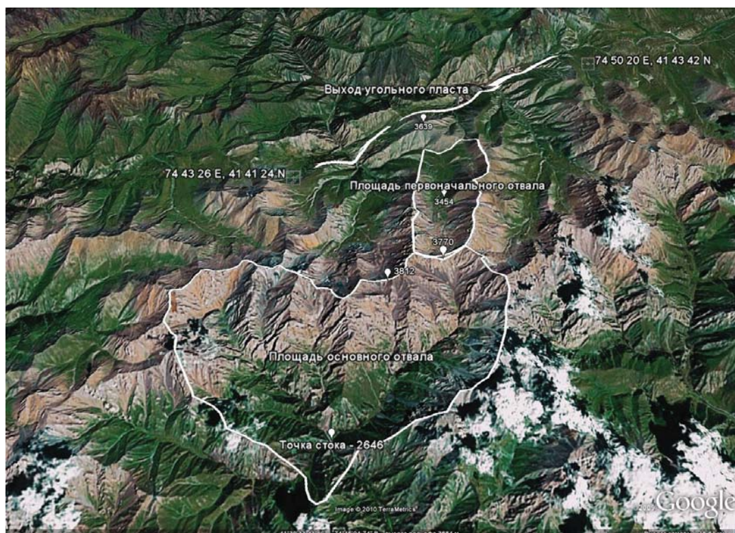
Рис. 4. План поверхности первоначального и основного отвалов вскрышных пород в объеме 15–16 млрд. м 3 из месторождения Кара-Кече на весь срок службы большого карьера.
