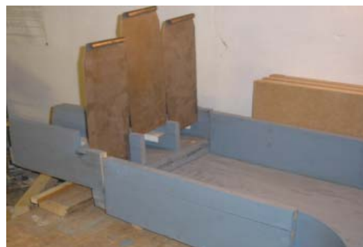
Рис. 2. Физическая модель вододелителя для каналов со сверхбурным течением: а – со снятыми затворами; б – с установленными затворами.
