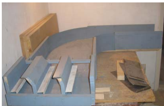
Рис. 2. Физическая модель вододелителя для каналов со сверхбурным течением: а – со снятыми затворами; б – с установленными затворами.
