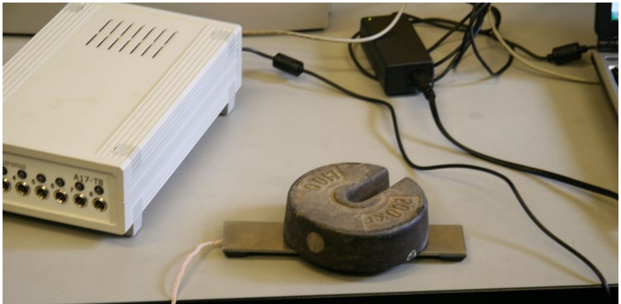
Рис. 8. Тарирование месдоз при помощи гири
