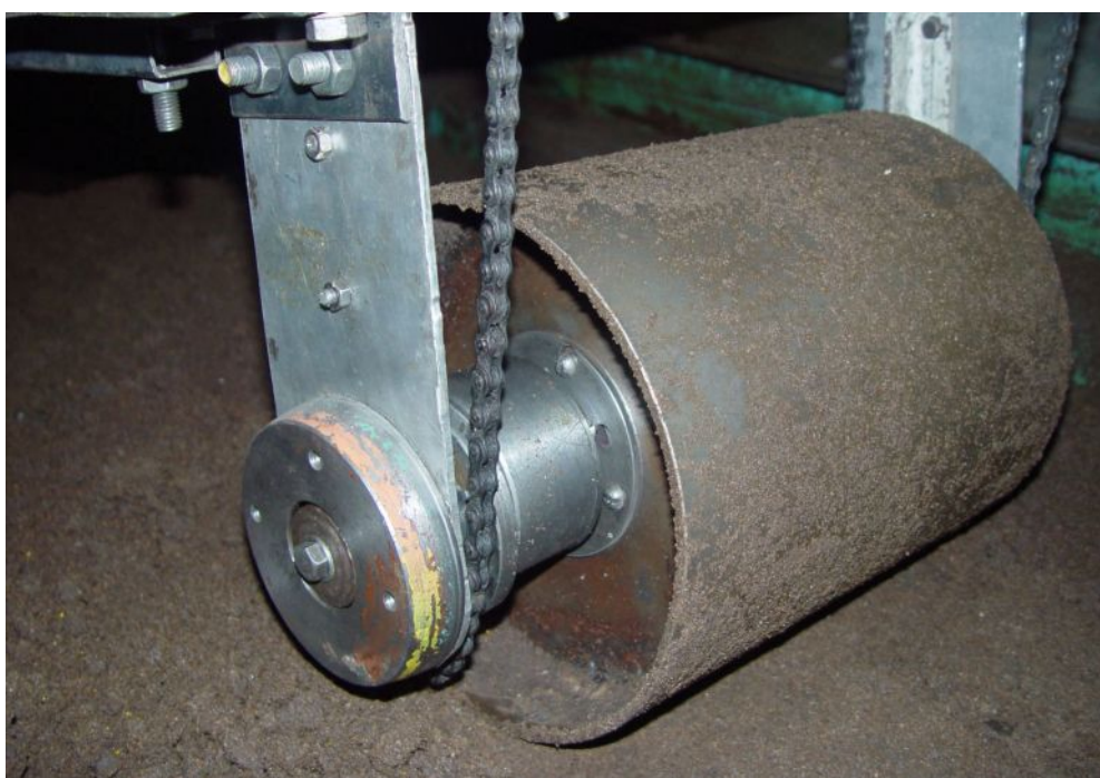
Рис. 1. Физическая модель дорожного катка
