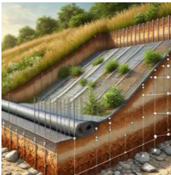
Рисунок 3.16. Композитное покрытие на склоне для стабилизации
