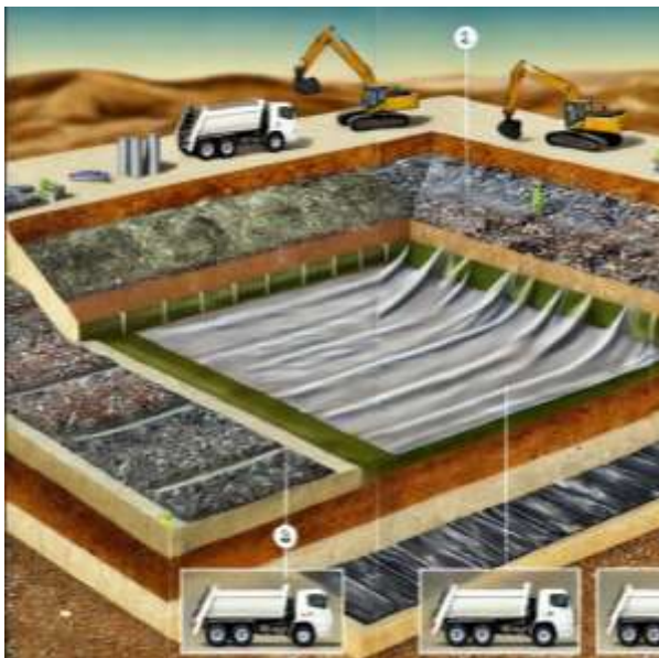
Рисунок 3.3. Пример использования геомембраны на полигоне ТБО
