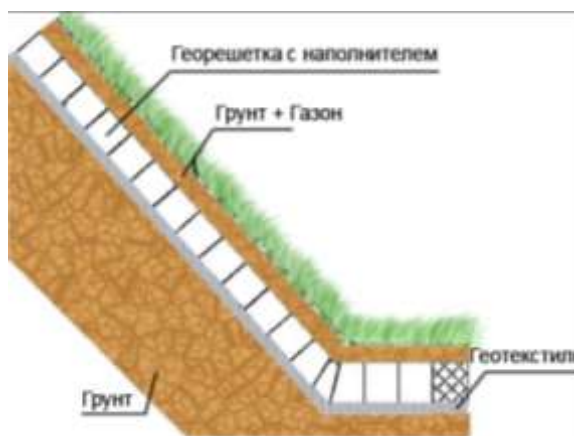
Рисунок – 5.1. Схема укрепления откоса с использованием геосетки и геотекстиля
