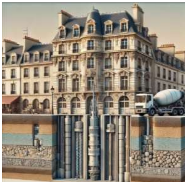
Рисунок – 3.7. Инъекция цементного раствора для стабилизации фундамента исторического здания в Париже
