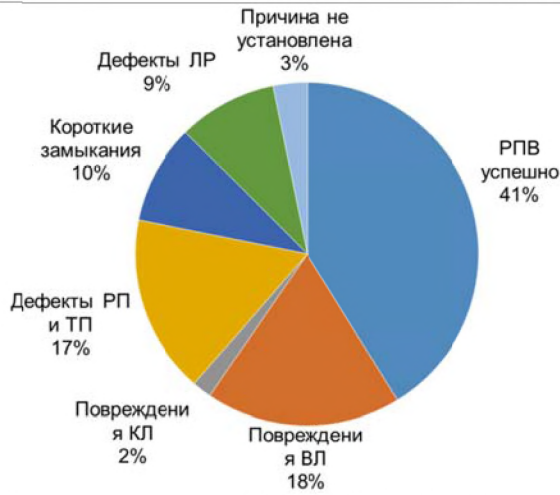
Рис. 8. Причины аварийных отключений 35–6 кВ ОАО «Востокэлектро»
