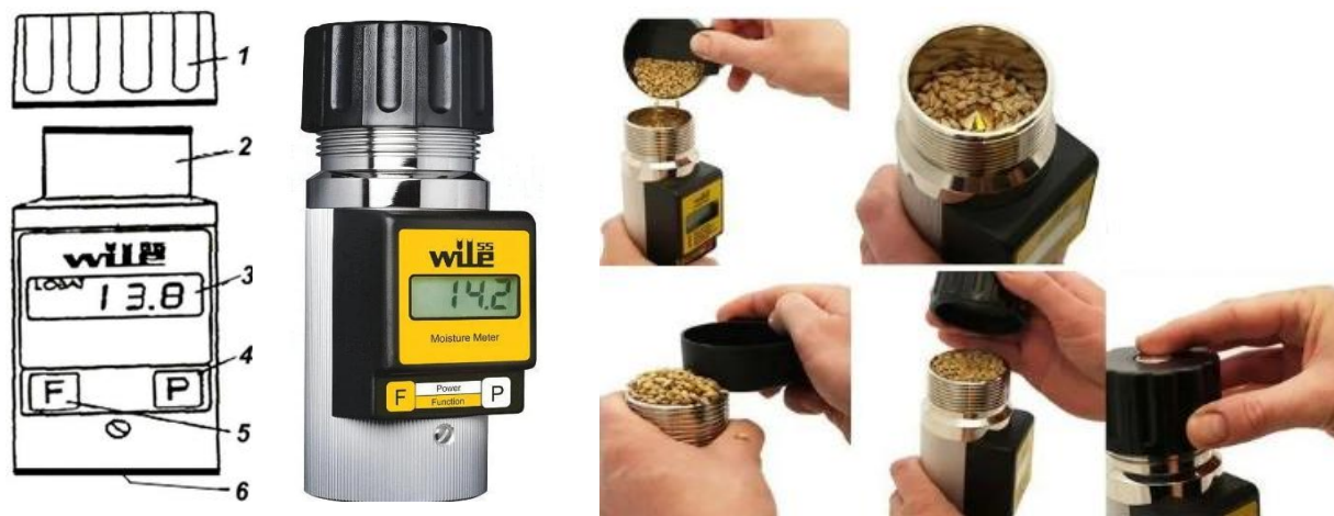
Рисунок 5 - Влагомер зерна WILE – 55 и процессы использования: 1-крышка; 2-измерительный цилиндр; 3-экран; 4-кнопка включения «Р»; 5-кнопка функции «F»; 6-скрытая батарея
