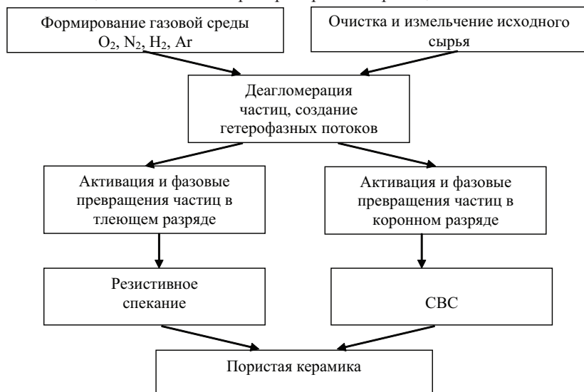
Рис. 4.1. Технология CVC спекания керамических материалов.
