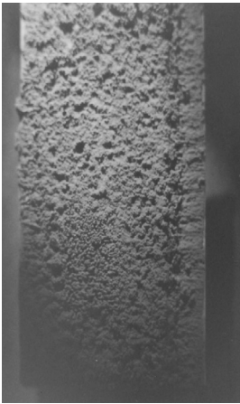
Рис. 4.11. Структура напыленного кремния. Ув. 1.
