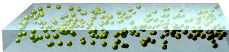
Рисунок 1 – Терагерц-инфракрасный конвертер – матрица, содержащая металлические наночастицы [1, 2]
