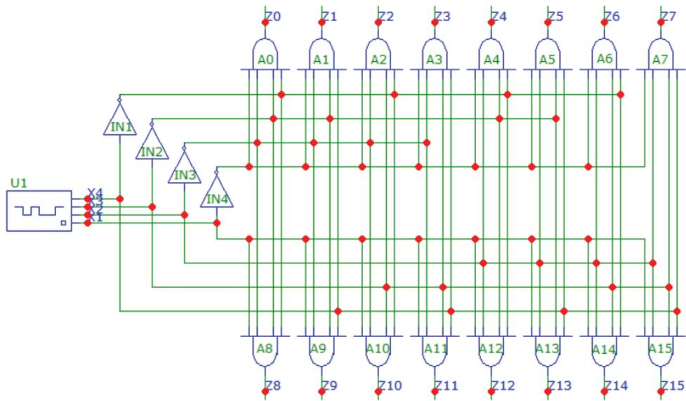
Рисунок 2 – Схема дешифратора, смоделированная в программе Micro-Cap
