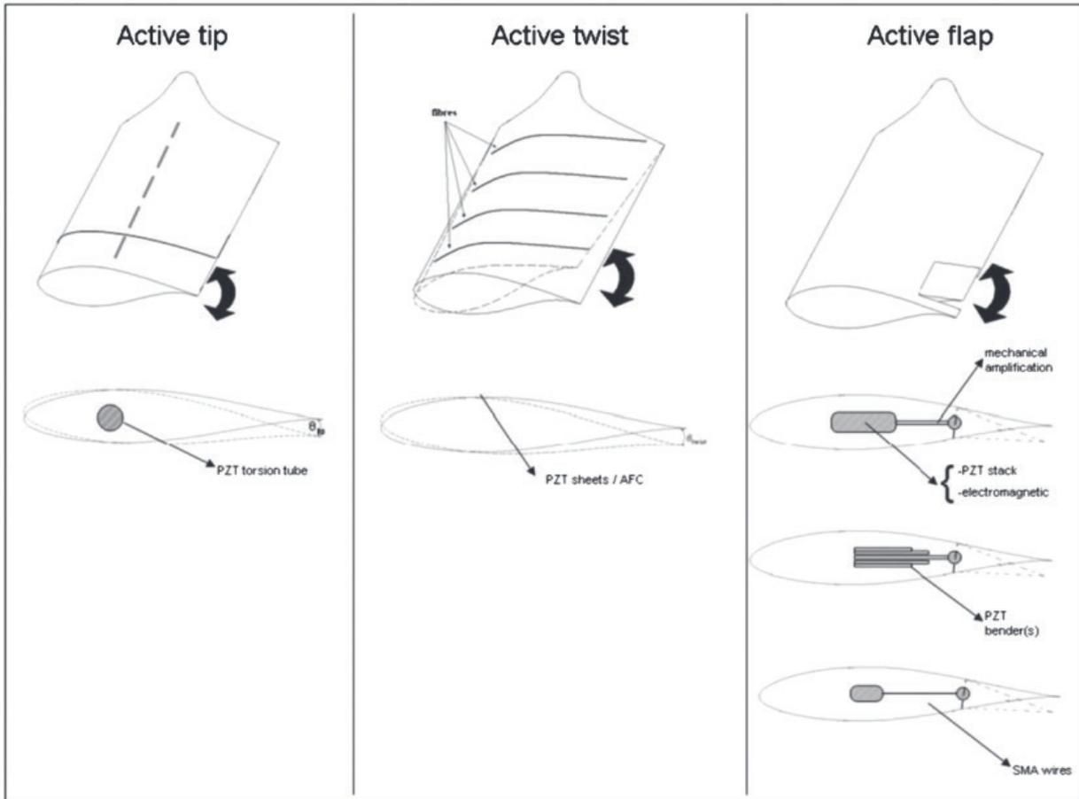
Рисунок 5 – Схема основных концепций интеллектуальных лопастей вертолета:
