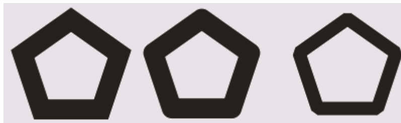
Рисунок 7.4 – Варианты оформления углов контура в местах излома линии
