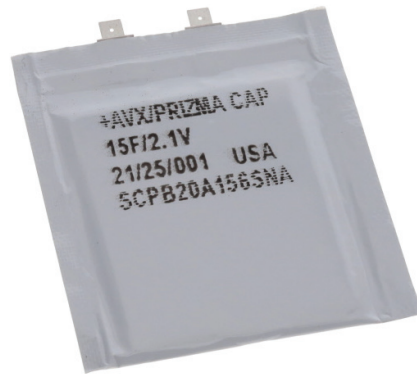
Рисунок 6 – Ионистор 15Ф, 2.1В габаритные размеры 48x45x2мм. темп. диапазон –55°С...+85°С
