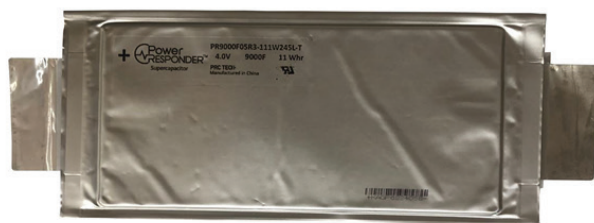
Рисунок 1 – Ионистор, емкость 9000 Фарад, ном. напряжение 4 В, габаритные размеры 245×111×5 мм
