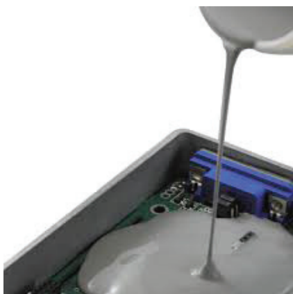
Рисунок 8 – Заливка электронной платы устройства жидким компаундом (пример)
