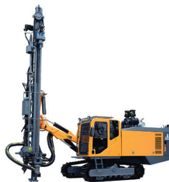
Рисунок 3 – Гидравлическая буровая установка консольного типа
