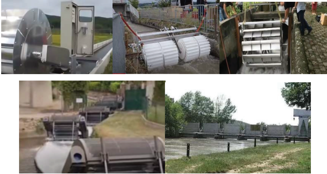
Рисунок 1 – Общий вид отдельных микро-ГЭС с лопастными горизонтальными турбинами и схемы их размещения на каналах и реках
