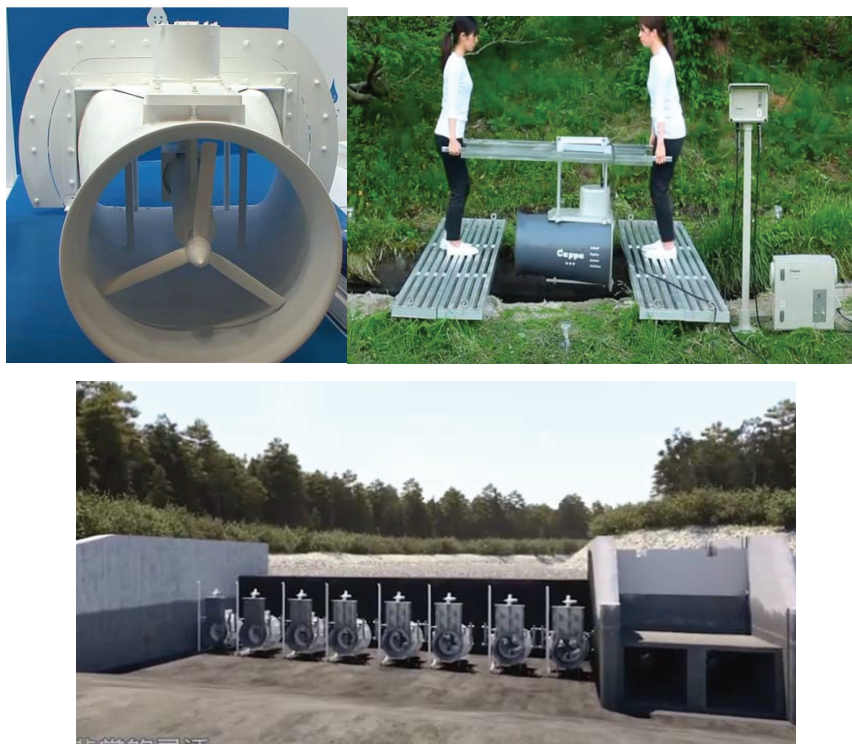
Рисунок 4 – Общий вид микро-ГЭС с осевыми турбинами и их размещение на каналах
