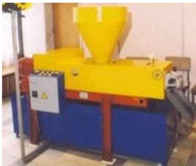
Рис.1.16. Маслопресс двухшнековый ЭКМ-2000-1
