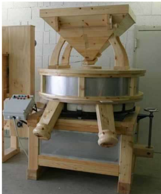
Рис. 1.4. Жерновая мельница GM - 70 компании «SHELDEM»
