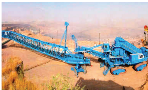
Комплекс мобильной дробилки с мостовым перегружателем (виды сверху и спереди)
