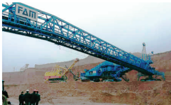
Комплекс мобильной дробилки с мостовым перегружателем (виды сверху и спереди)
