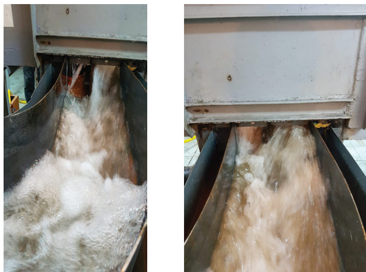
Рисунок 3 – Истечения через поворотное сооружение в отводящий лоток при расходах воды: а – при Q = 0,54Q_{\max} ; б – Q = Q_{\max}
