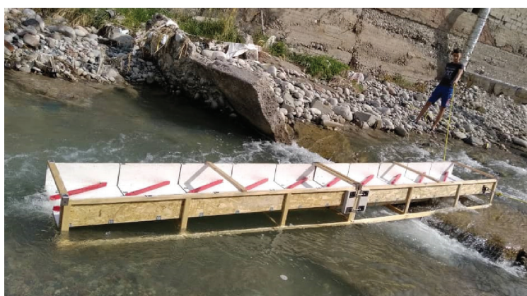
Рисунок 3 – Испытания на прогиб соединенных встык двух макетов. Один из них погружен в поток речной воды и удерживается с помощью натянутых по берегам веревок
