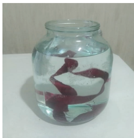
Рисунок 5 – Лента из 100 % хлопка, смоченная в воде. Видно, что погруженная лента находится на плаву
