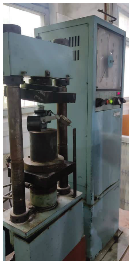
Рисунок 3 – Поверка ДОСМ-3-5 на гидравлическом прессе П-10
