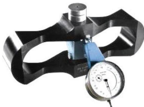
Рисунок 1 – Динамометр ДОСМ-3-5, 5 тс/50 кН
