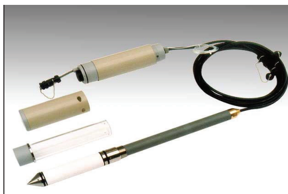
Рисунок 6 – Стационарный пьезометр, устанавливаемый в наблюдательных скважинах для долговременного мониторинга
