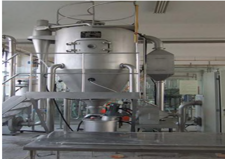
Рис.1. Распылительная дисковая сушилка Q = 1000 кг/ч
