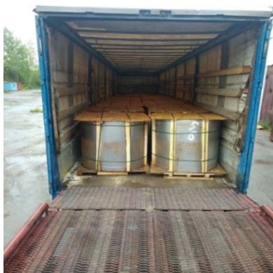
Рисунок 10 – Контейнер для битума из листового металла и фанеры
