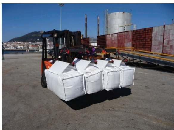
Рисунок 5 – Перемещение наполненных PolyCube с помощью вилочного погрузчика
