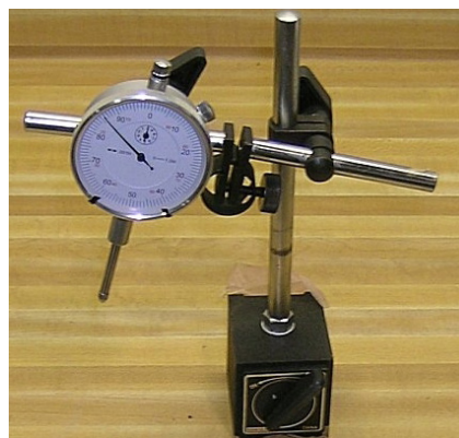
Рисунок 2 – Микрометр на магнитном штативе
