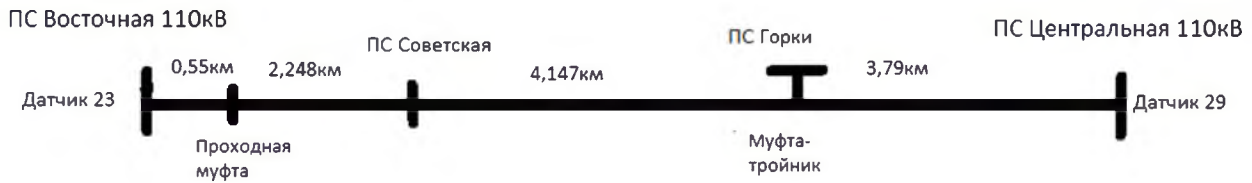
Рис.1 Схема КЛ. ПС Восточная – ПС Центральная.
