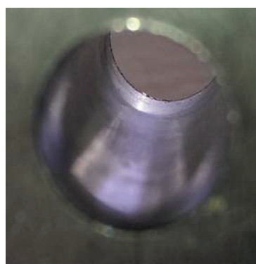
Рисунок 13 – Качество обработанных поверхностей: 1 – сверлом с конической заточкой; 2 – сверлом с двухплоскостной заточкой
