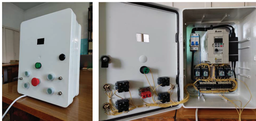
Рисунок 7 – Общий вид пульта управления механизмом подачи инструмента буровой машины
