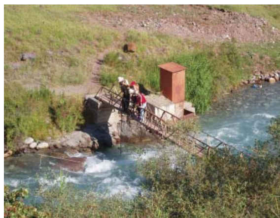
Рис. 1. Измерение скорости течения потока на гидропосту Белогорка.
