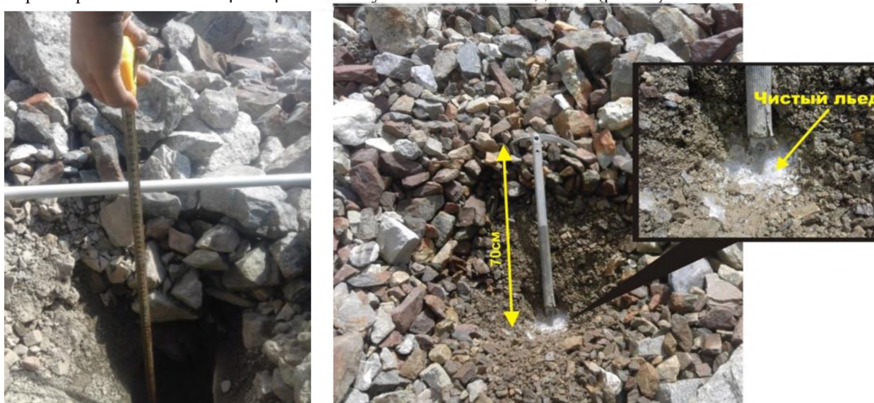
Рис. 3. Измерение толщины мореного чехла на забронированном участке ледника и искусственное обнажение льда. В точке измерения толщина мореного чехла составила 70 см.
