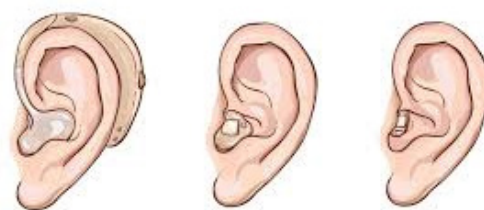
Рисунок 2 – Типы ношения слуховых аппаратов: заушные, внутриушные внутриканальные
