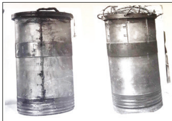
Рисунок 3 – Общий вид втулок цилиндра с установленными термодпарами
