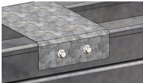
Рис. 3б. Крепление скобы с фермой на самосверлящих самонарезающих винтах
