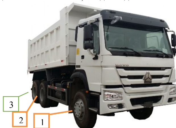
Рис. 3. Nowo модель ZZ3257N3847 китайского производства: 1, 2, 3 – номера осей.
