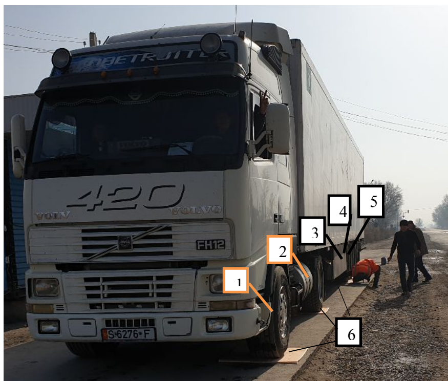
Рис. 4. Седельный тягач Volvo FH12.420 (сдвоенные колеса на второй оси): 1,2,3,4,5 – номера осей пятиосного седельного тягача; 6 – планшеты для определения отпечатков колес.
