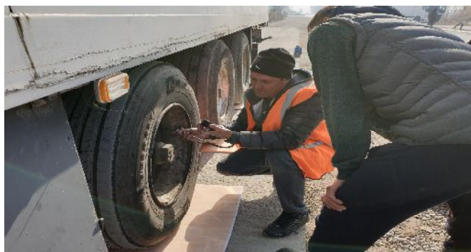
Рис. 6. Измерение давления колес манометром у 5-ти осного седельного тягача Volvo FH12.420
