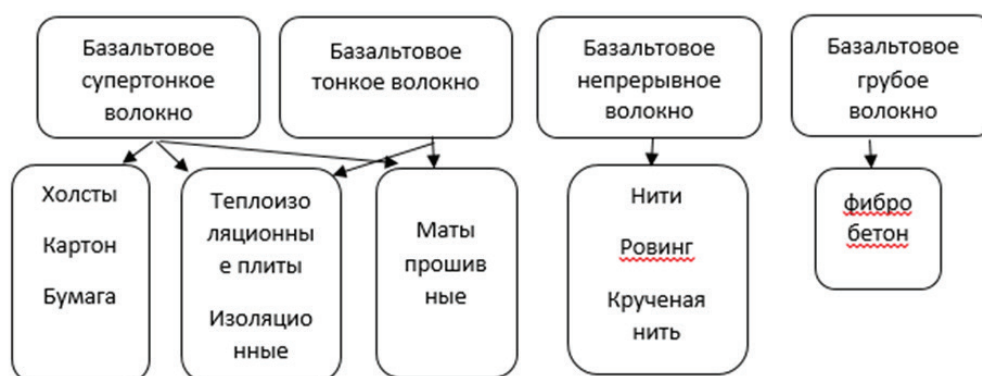
Рисунок 2 – Разновидность базальтовых волокон и изделий из них
