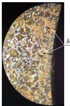
Рисунок 1 – Фотография микроструктуры металла поверхностного слоя отверстия: \delta – глубина дефектного поверхностного слоя отверстий
