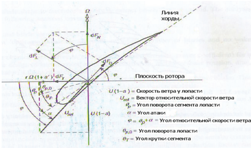
Рисунок 3 – Геометрия лопасти
