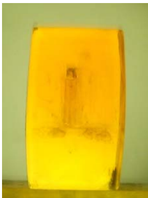
Рис. 2. Образец №5 (призма) без остаточных напряжений после пластической деформации (бочкообразование).
