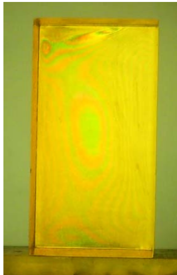
Рис. 11. Образец №9 с плоскополяризованным остаточным напряжением (перпендикулярная к плоскости поляризации сторона ДА)
