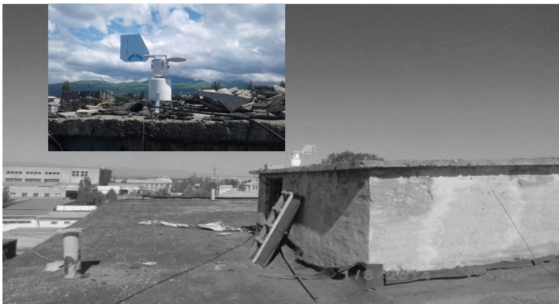
Рисунок 1. Пыльцеуловитель Ланзони Стационарный пост аэриобиологических наблюдений в г. Каракол
