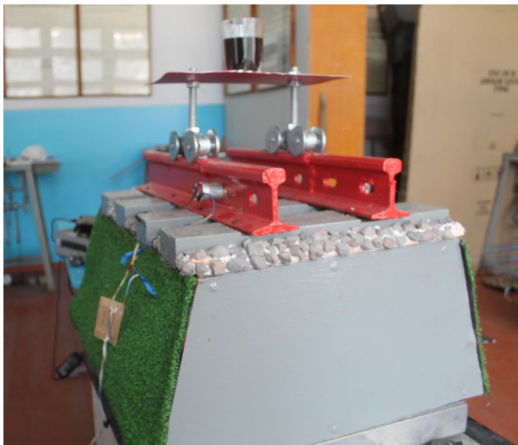
Рисунок 4.16 - Бездемпферная модель на сейсмоплатформе
