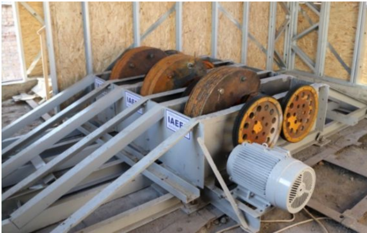
Рисунок 2 – Общий вид мобильной вибромашины и схема расстановки акселерометров на платформе
