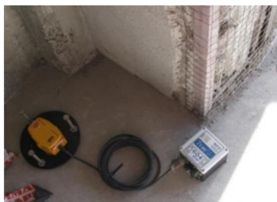
Рисунок 4.2 – Общий вид записывающего устройства. Каждая станция оснащена 24 битным CUBE дигитайзером, подключенного к 4,5 Гц геофона (желтый)
