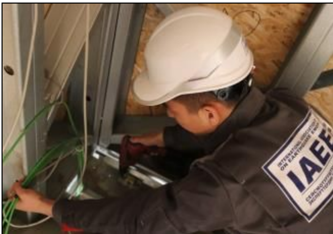
Рисунок 2.29 – Процесс установки датчиков-акселерометров на покрытии платформы, на полу второго этажа и снизу фермы над вторым этажом
