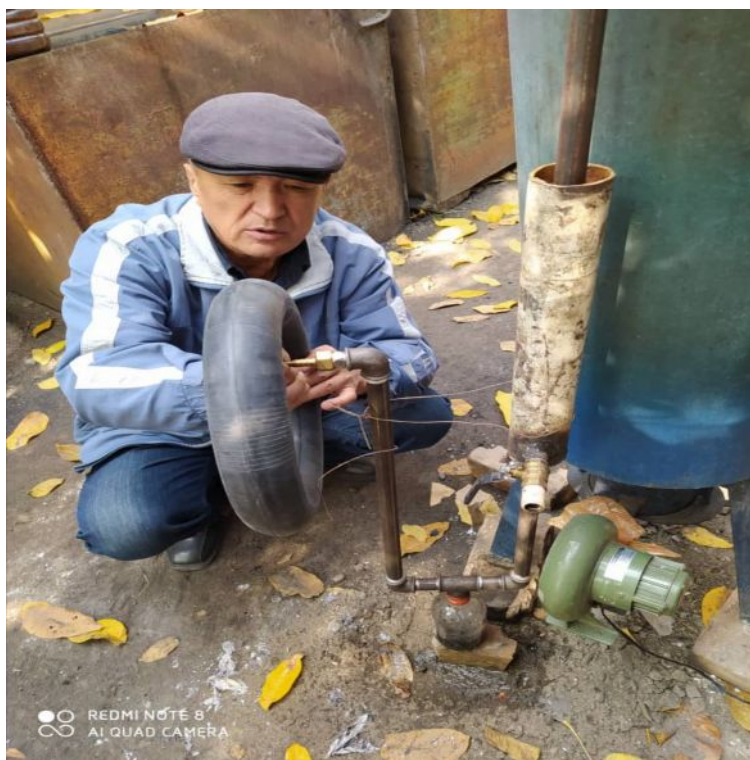
Рис. 2. Общий вид новой экспериментальной пиролизной установки
