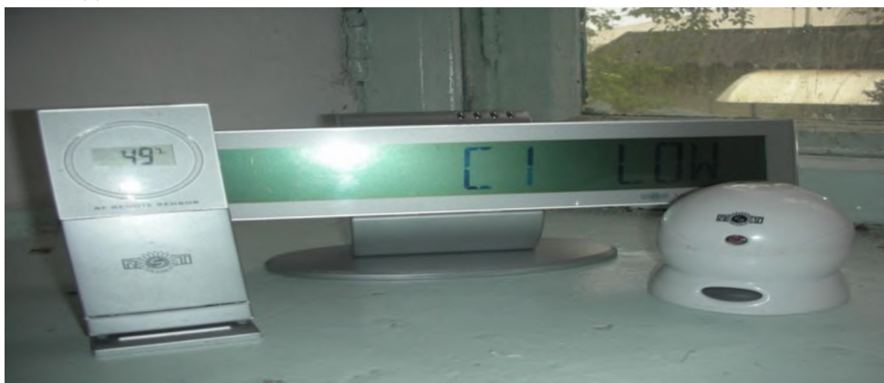
Рисунок 1. Метеостанция «Цифровой погодный центр с бегущей строкой 02977», измеритель интенсивности UV лучей «RST 02871» и дополнительный датчик RF
