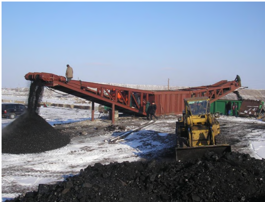
Рис. 2. Конструкция комплекса ДСКА производительностью 750 т/час в варианте поставки ООО “Каражыра” (Республика Казахстан)
