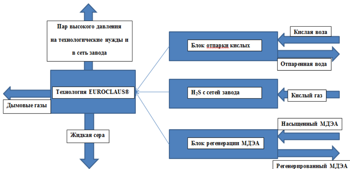
Рисунок 1 – Общая схема технологического процесса установки производства серы.
